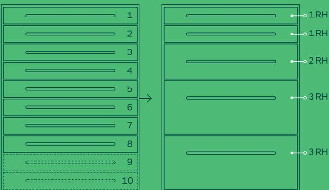
Das Mann-Rastersystem mit 8–10 Rasterhöhen und eine Beispiel-Konfiguration mit fünf Schubladen (1+1+2+3+3=10 Rasterhöhen)
