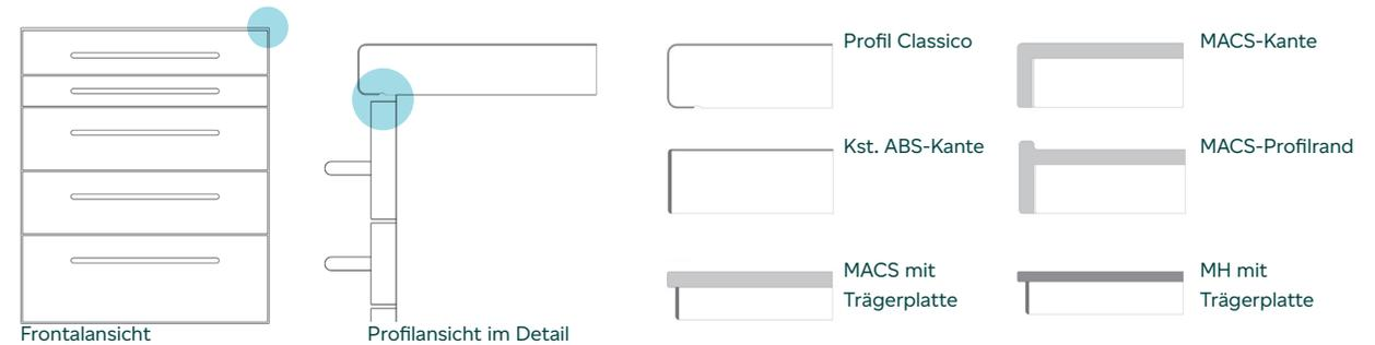
**Z** TYP — Mit Zierleiste in 8, 9 oder 10 Rasterhöhen, geeignet für folgende Arbeitsplatten:
