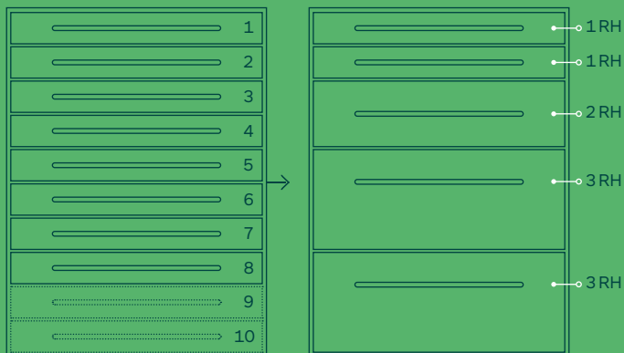
Das Mann-Rastersystem mit 8–10 Rasterhöhen und eine Beispielformatung mit fünf Schubladen (1+1+2+3+3=10 Rasterhöhen)
